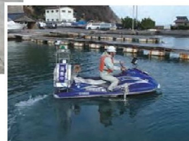
水上バイクに測深機と測位装置を搭載し、あらゆる水域へ▶
