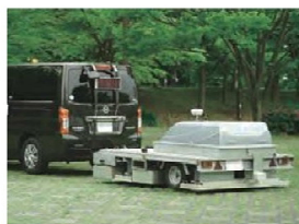
▲ 深層空洞調査に最適な「牽引型」
