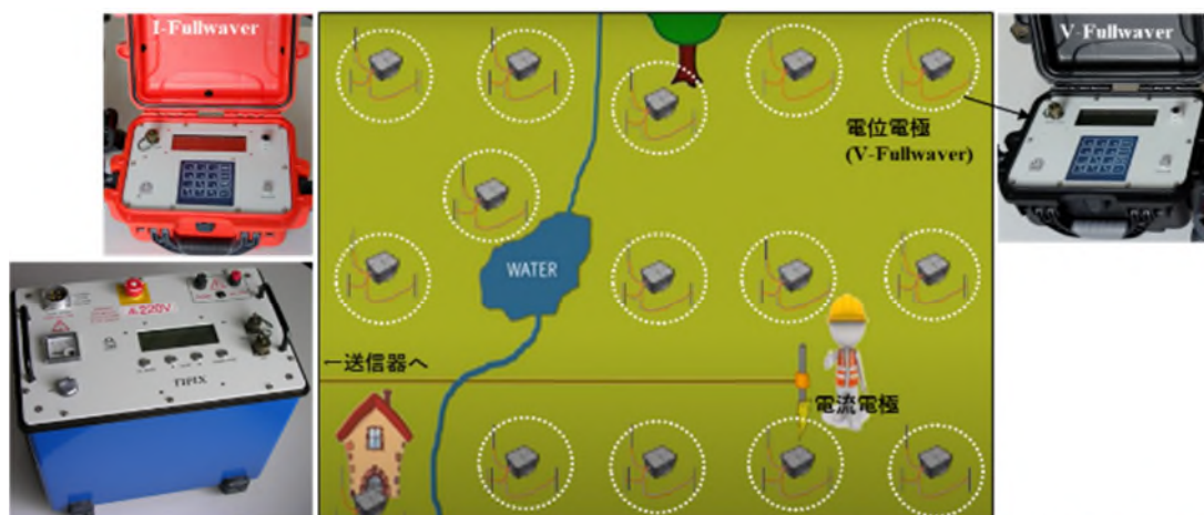
ケーブルレス電気探査装置と 測定イメージ
