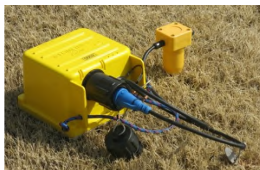
ケーブル不要の地震探査装置
