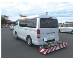
▲ 浅層部路面下空洞調査に「車載型」
