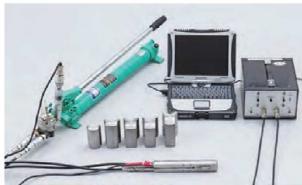
▲ GoTEN-tk (孔内局部載荷試験機)
