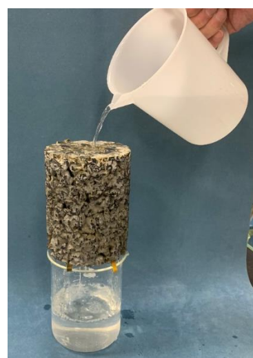
透水性地盤改良体 ( k=1.0 \times 10^{-3} \text{m/sec} )
