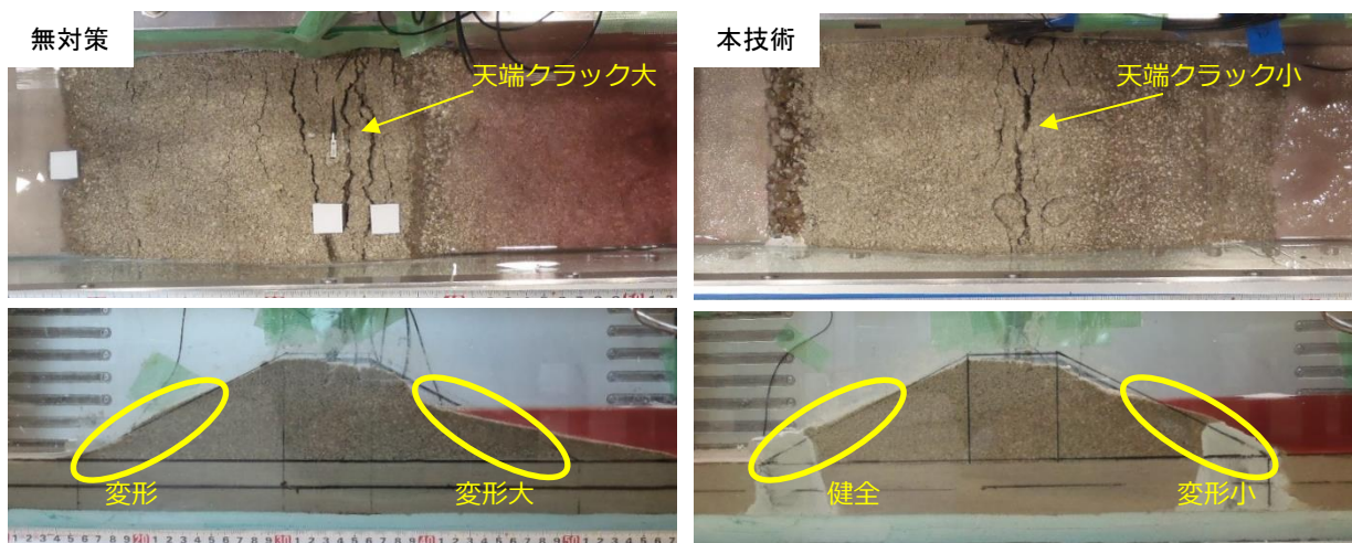
加振後の模型の状況（上：土槽上面、下：土槽正面）
